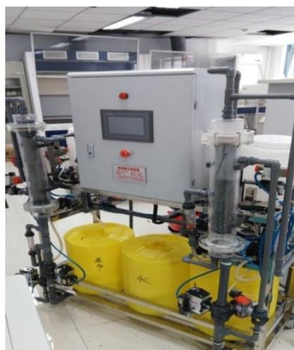
图2 海洋资源开发利用实验室工程设备-固液膜分离工艺流程设备
